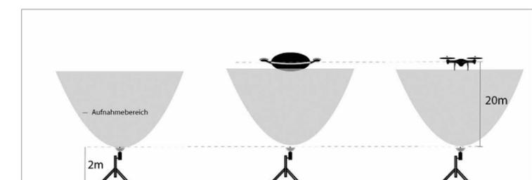
Versuchsaufbau: links Negativkontrolle, mitte Flug der LTA-Drohne, rechts Flug des Hexacopter
