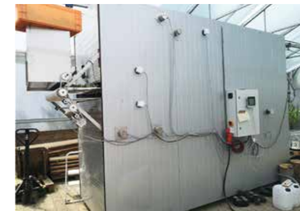
Abbildung 1: Bandtrockner während dem Trocknungsvorgang von Pfefferminze
